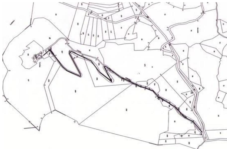
Fig.4 - Tracciato della rete idrica e fognaria
